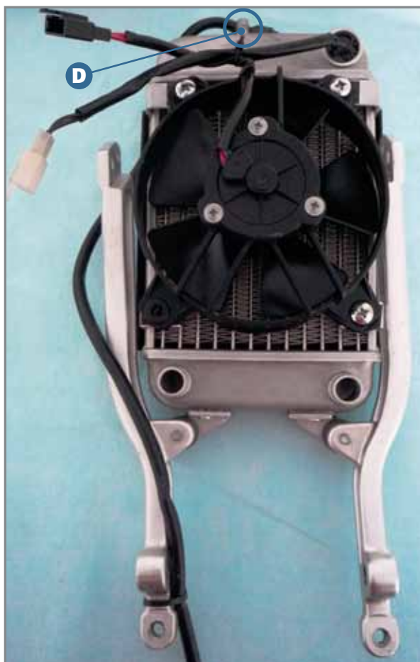
Complete radiator: the upper pin (D) is highlighted.
